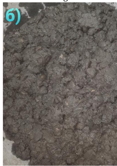
2-rasm. Bazaltfibrobeton qorishmalarining birinchi (a) va ikkinchi (b) tur bo‘yicha tayyorlangandagi holatlari
