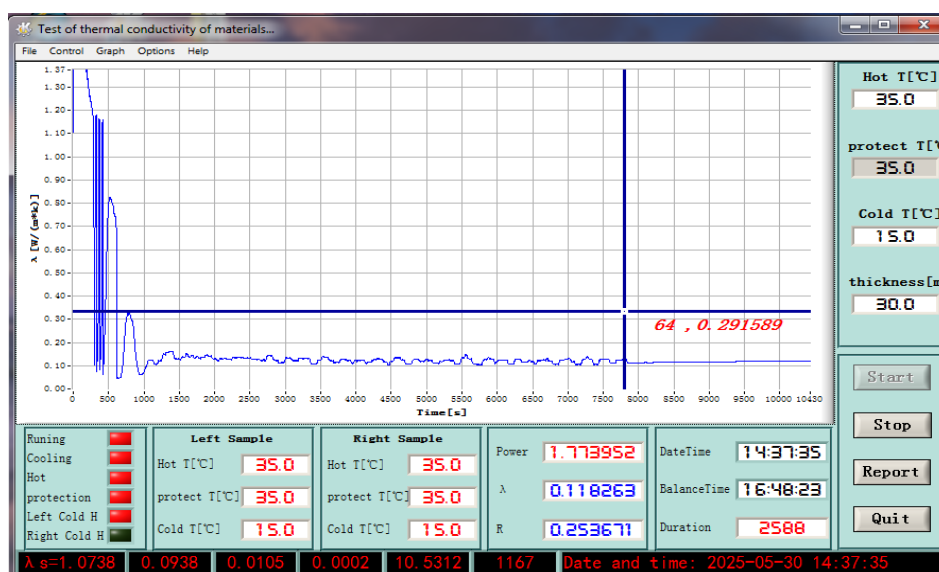
3– rasm. namunalarni XND-2-3030C uskunasi sinash natijasi diagrammasi
