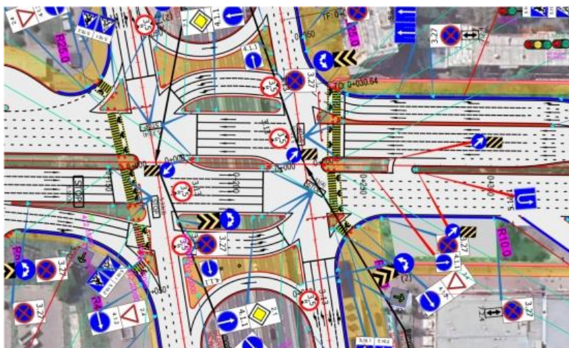
7-rasm. KHAY ko'chasida o'nga va chapga buriluvchi transport vositalari uchun kanallashtirilgan yo'l
