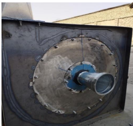
3-rasm. Eksperimental pnevmatik qurilma og'ziga ulangan kichik quvurchalardan biri
