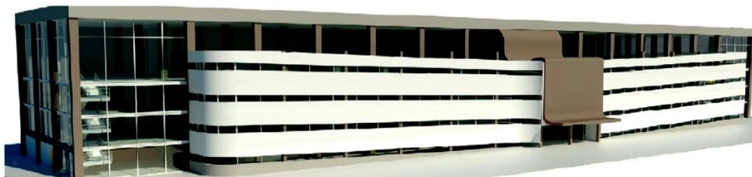
4-rasm. Avtomobil-joylari soni 250 ta bo'lgan, 4 qavatli, rampali yopiq saqlash binosi loyihasi
