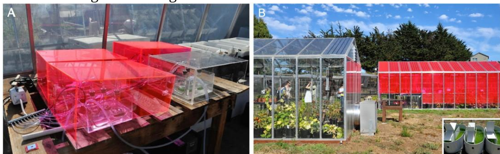
4-rasm. A: LR305 asosida yaratilgan organik LSC, suv o'tlari yetishtirishda qo'llanilgan. B: LSCsiz issiqxona (chapda) va LSC bilan (o'ngda) sho'rlangan ekinlarni yetishtirish uchun. [12] Richards, B.S. va boshqalardan qayta chop etilgan.
