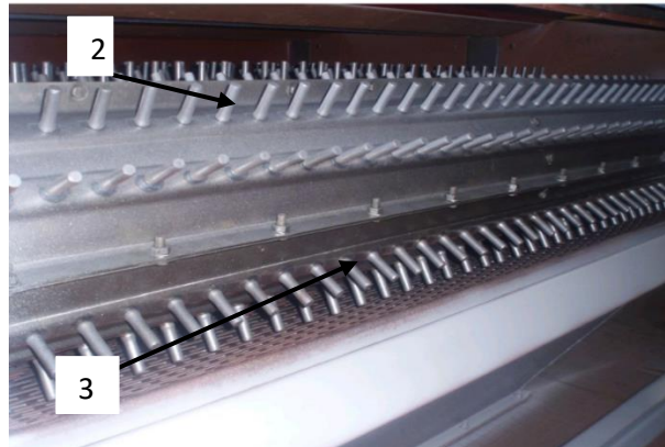
2-rasm. Paxtani mayda iflosliklardan tozalash uskunasi mavjud qoziqchali-plankali barabanining sxemasi va umumiy ko'rinishi 1-qoziqchali-plankali baraban, 2-qoziqchalar, 3-to'rtli yuza, 4-paxta bo'lakchasi.
